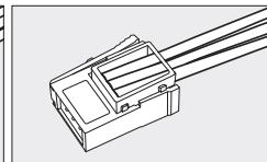
2. 電線被覆を剥がさずにコネクタ挿入口の奥まで押し込んだ状態で
